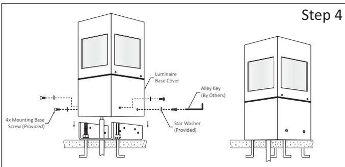
**Step 4 - Install Luminaire Base Cover:**
