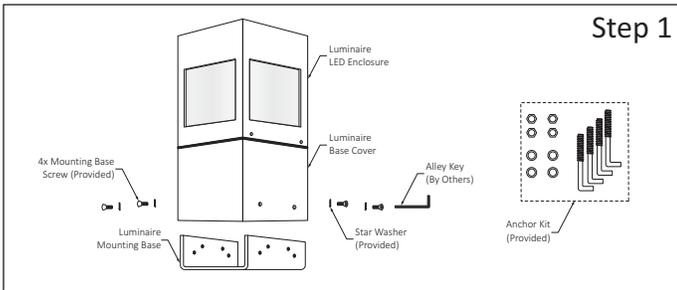
**Step 1 - Disassemble Luminaire Parts for easy Installation:**
